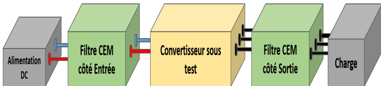
Figure I-10 : Schéma bloc des différents éléments d'une chaîne de puissance raccordée à un bus HVDC
