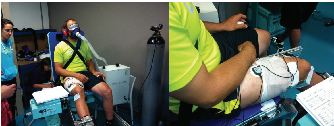
Figure 3.1 : Installation sur le CON-TREX avec l'Altitrainer. Spectroscopie dans le proche infrarouge (NIRS) et EMG du vastus lateralis .
