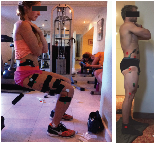
Figure 2.18 : Calibration des goniomètres. Les repères osseux sont indiqués avec les marqueurs réfléchissants sur la hanche (épine iliaque antéro-supérieure, épine iliaque postéro-supérieure, grand trochanter), le genou (condyle fémoral latéral) et la cheville (malléole externe).
