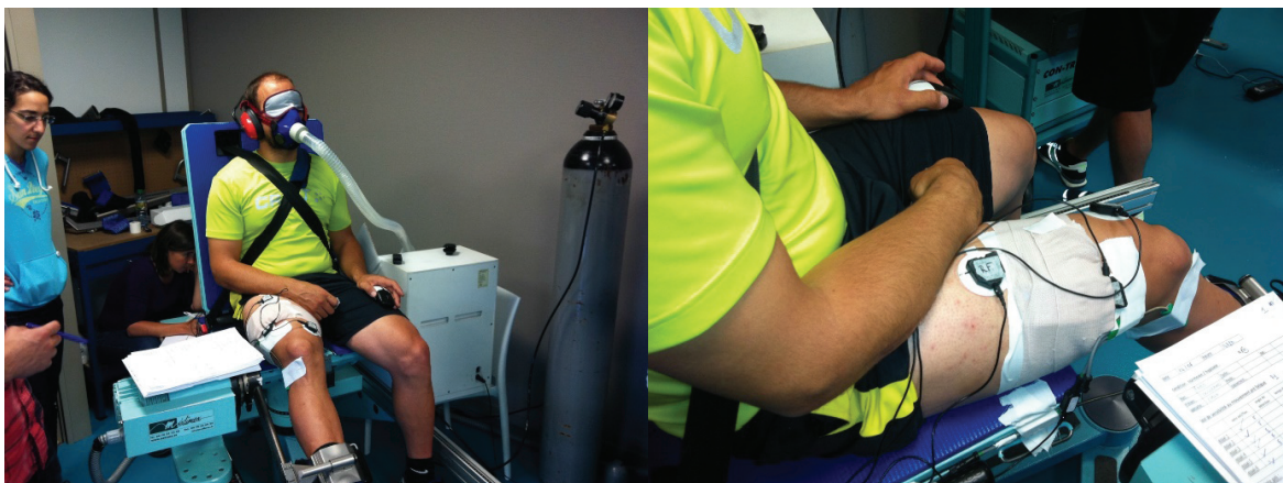
Figure 3.1 : Installation sur le CON-TREX avec l'Altitrainer. Spectroscopie dans le proche infrarouge (NIRS) et EMG du vastus lateralis .
