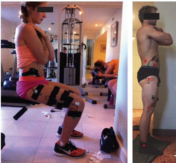
Figure 2.18 : Calibration des goniomètres. Les repères osseux sont indiqués avec les marqueurs réfléchissants sur la hanche (épine iliaque antéro-supérieure, épine iliaque postéro-supérieure, grand trochanter), le genou (condyle fémoral latéral) et la cheville (malléole externe).
