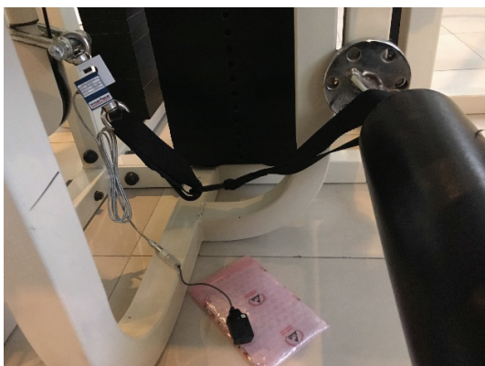
Figure 2.21 : Enregistrement de la force lors des CMV isométriques. Capteur de force synchronisé directement avec l'EMG par un adaptateur émettant vers la station de base Delsys.
