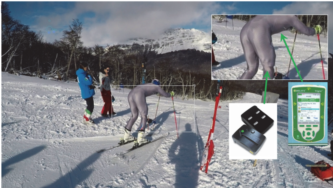
Figure 2.7 : Skieur équipé au départ d'une manche de Géant. Il se prépare dans le portillon de départ et sa jambe droite est instrumentée sous la combinaison.
