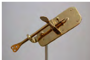
Figure 1.4 – Reproduction récente du microscope inventé par van Leeuwenhoek [11]
