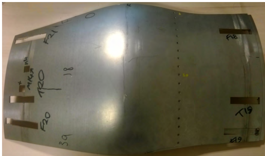
FIG. 51 : Secteur circulaire de pièce de nacelle, mise en forme à 20 % de déformation. Pièce fournie par Safran Nacelles.
