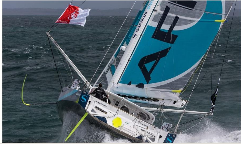
Figure 2-6: Coque de bateau en matériau composite carbone/époxy [9]
