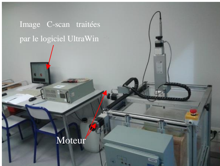
Figure 4-3: Machine de contrôle ultrasonore (C-Scan)
