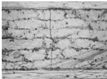
Figure 2-19: Exemple de fissuration transverse de la matrice d'un stratifié carbone/époxyde [51]
