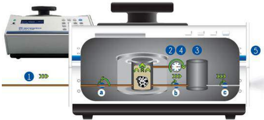
Figure 3.6 – Schéma montrant le fonctionnement de l'AccuPyc II 1340 de Micromeritics. Voir le texte ci-dessus pour la procédure expérimentale.
