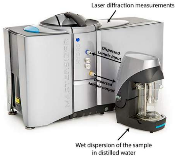
Figure 3.4 – Schéma simplifié du fonctionnement du granulomètre Mastersizer 3000 de Malvern utilisant la dispersion de l'échantillon par voie humide.
