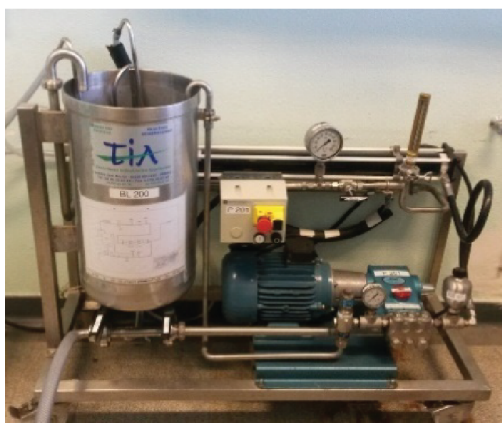
Figure 40 : Photo et schéma du pilote d'osmose inverse (EPOC-LPTC, Université de Bordeaux).
