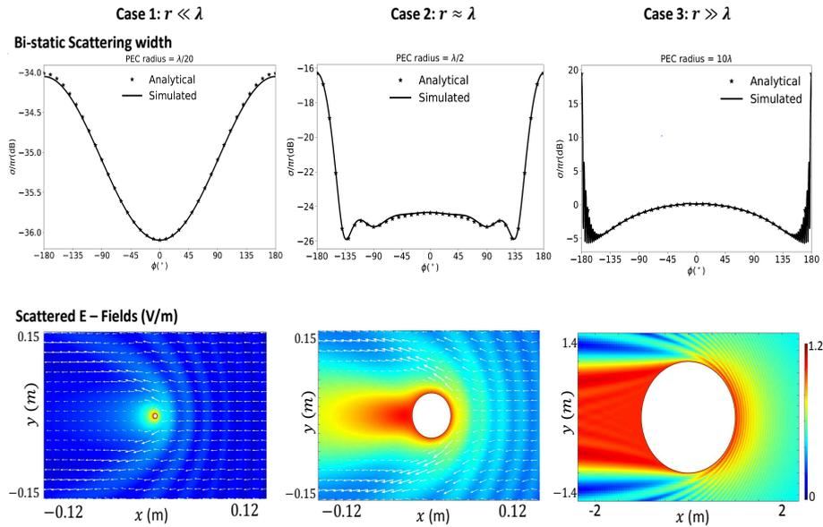
FIGURE A.15: Rayonnement d'un cylindre métallique lorsque celui-ci est illuminé par une onde électromagnétique. Le cas où le champ  $E$  est parallèle à la hauteur du cylindre est considéré. Trois cas sont présentés: (1) lorsque le rayon du cylindre est très petit par rapport à la longueur d'onde. (2) Lorsque le rayon du cylindre est comparable à la longueur d'onde. (3) Lorsque le rayon du cylindre est très grand par rapport à la longueur d'onde.
