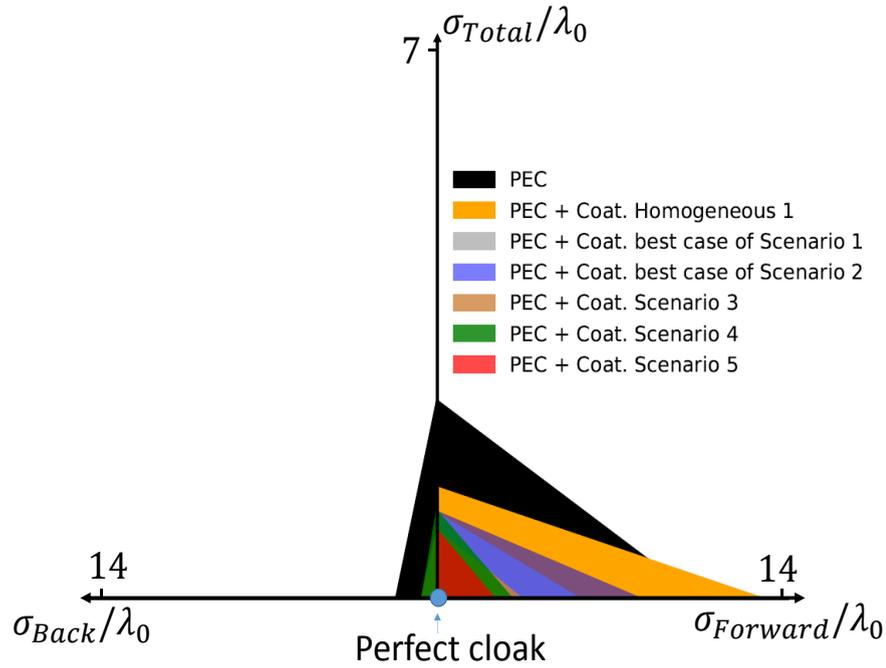
FIGURE A.18: Représentation triangulaire du rayonnement vers la source ( $\sigma_{Back}$ ), rayonnement vers l'avant ( $\sigma_{Forward}$ ) et le rayonnement total ( $\sigma_{Total}$ ) pour un cylindre métallique, et quand il est couvert par plusieurs scénarios de revêtements.
