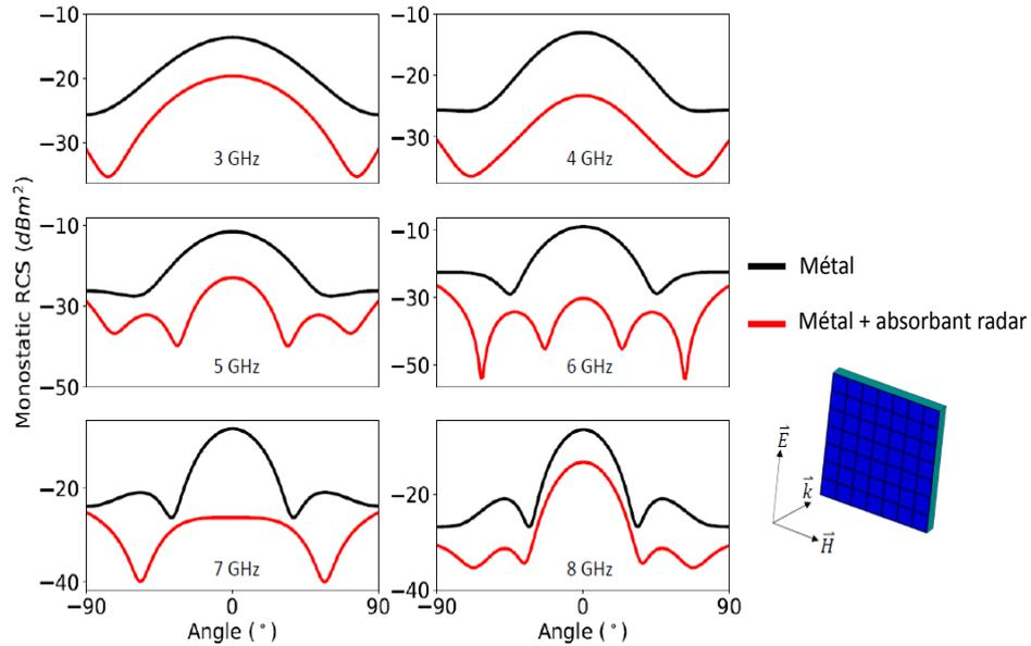
FIGURE A.6: SER du métal (noir) et de l'absorbant radar (rouge) à 3, 4, 5, 6, 7 et 8 GHz.
