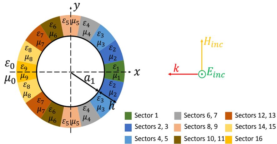
FIGURE A.16: Un cylindre métallique de rayon  $a_1 = \lambda/2$  entouré de 16 secteurs de diélectrique ayant une épaisseur de  $h = \lambda/5$ , illuminé par une onde polarisée verticalement.
