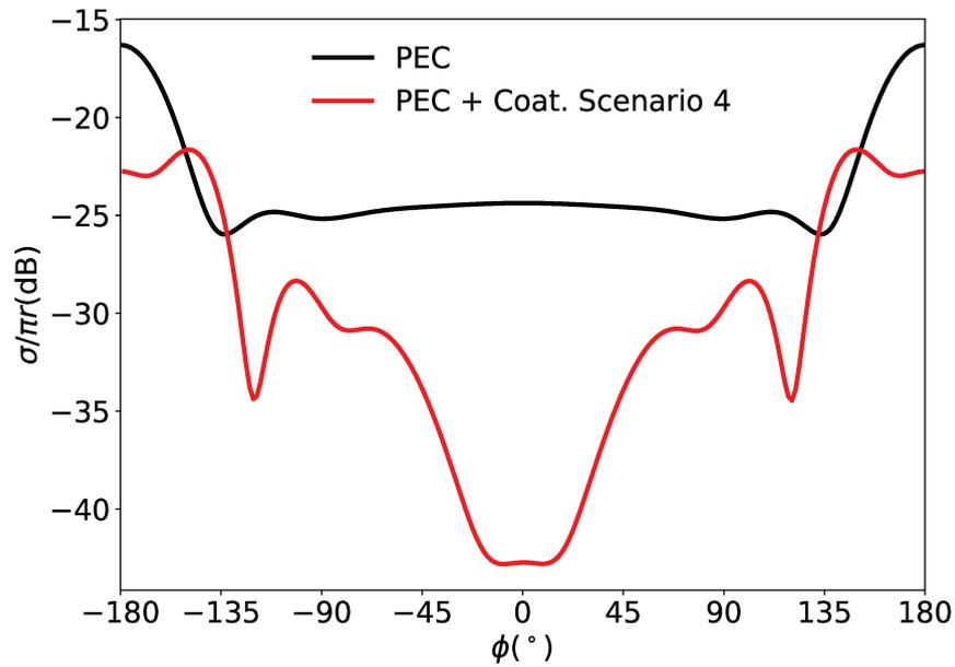
FIGURE A.17: Signature équivalente radar bistatique normalisée d'un cylindre métallique de rayon  $\lambda/2$  (en noire) and avec le revêtement de 16 secteurs (en rouge). Les simulations ont été réalisées à 3 GHz.
