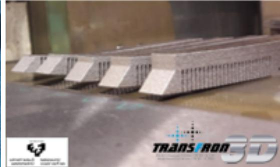
FIGURE 6.7 – "Twin cantilever" sur le support [19]      FIGURE 6.8 – Retour élastique résultant après découpe [48]
