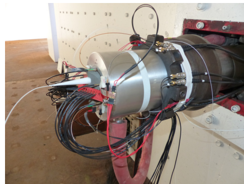
(b) Édifice pyrotechnique à la bouche du lanceur
