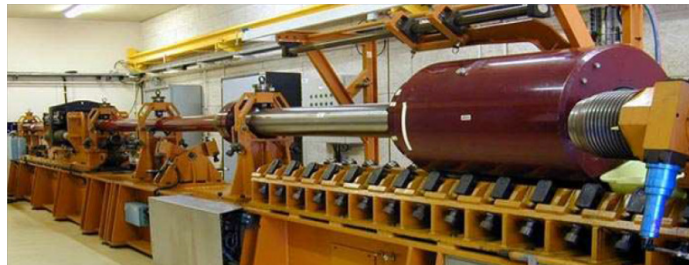
(a) Lanceur à poudre Arès. Les vitesses d'impact sont comprises entre 800 à 2300 \text{ m}\cdot\text{s}^{-1} suivant la masse du projectile et la masse de poudre.
