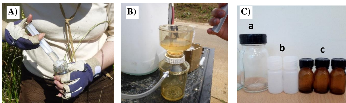
Figure I.28 : Filtration des eaux avec A) des filtres-seringues ou B) une unité de filtration et C) flacons d'échantillonnage
