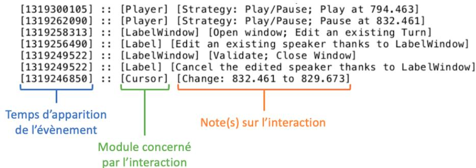
FIGURE 4.2 Exemple de traces dans un fichier log
