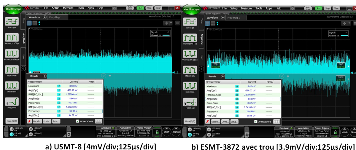
FIGURE 3.27 – Comparaison dans le domaine temporel a) USMT-8 b) ESMT-3872
