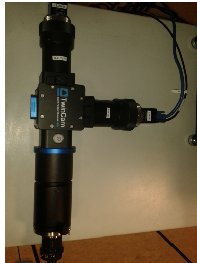
(b) Miroir semi-réfléchissant et les deux caméras.
