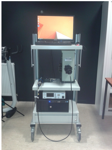
(a) Colonne complète avec l'ordinateur, les caméras, le miroir, la source de lumière et le fibroscope.
