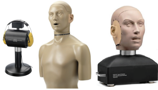
FIGURE 3.2 – Exemples de dispositifs physiques pour la mesure d’atténuation. À gauche, un des modèles les plus simples. Au milieu : simulateur de tête et buste. À droite : tête artificielle seule. Les modèles du milieu et de droite permettent de reproduire l’influence de la présence d’un auditeur sur le champ sonore.
