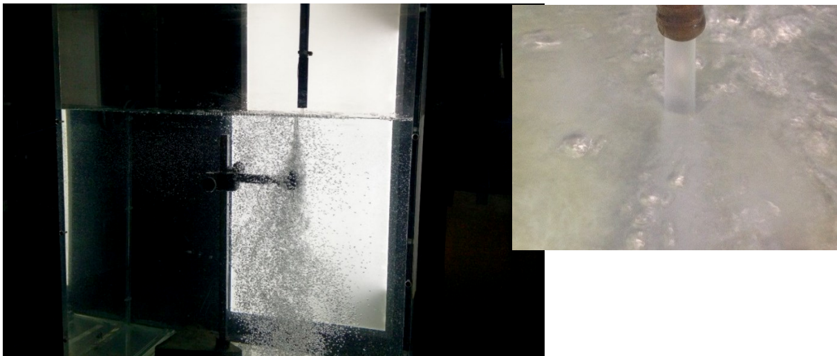
Figure 9.6-6 : Vue de la quatrième manipulation, Une sonde optique mesure dans le nuage de bulles. La buse est un placée à l'avant d'un tube droit de 1.2 m de long de manière réduire les écoulements secondaires. Zoom sur le jet.
