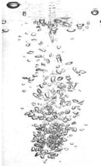
Figure 5.2-1 : Nuage de bulles créé par un jet plongeant ( U_0 = 2.25 \text{ m/s} , D_0 = 4 \text{ mm} , L_c = 50 \text{ mm} ) Roy et al (2013)
