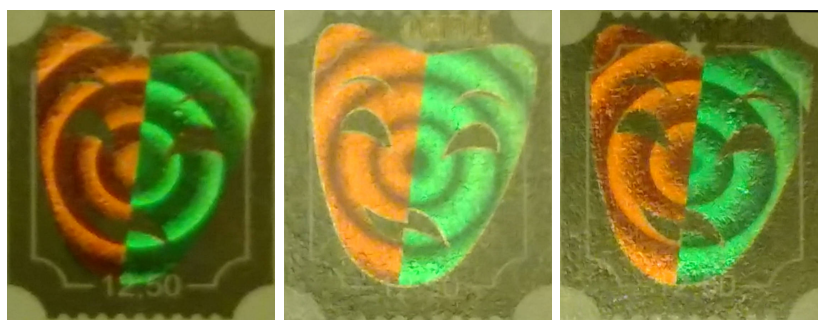
FIGURE 4.20 – Images d'un hologramme Surys prises à trois angles consécutifs. Dans l'hologramme, nous observons un effet «DID™ Wave graphique +», des cercles concentriques évoluent suivant un effet de zoom. La portion de ces cercles située dans la partie gauche de l'hologramme présente un effet inversé par rapport aux cercles situés dans la partie droite.
