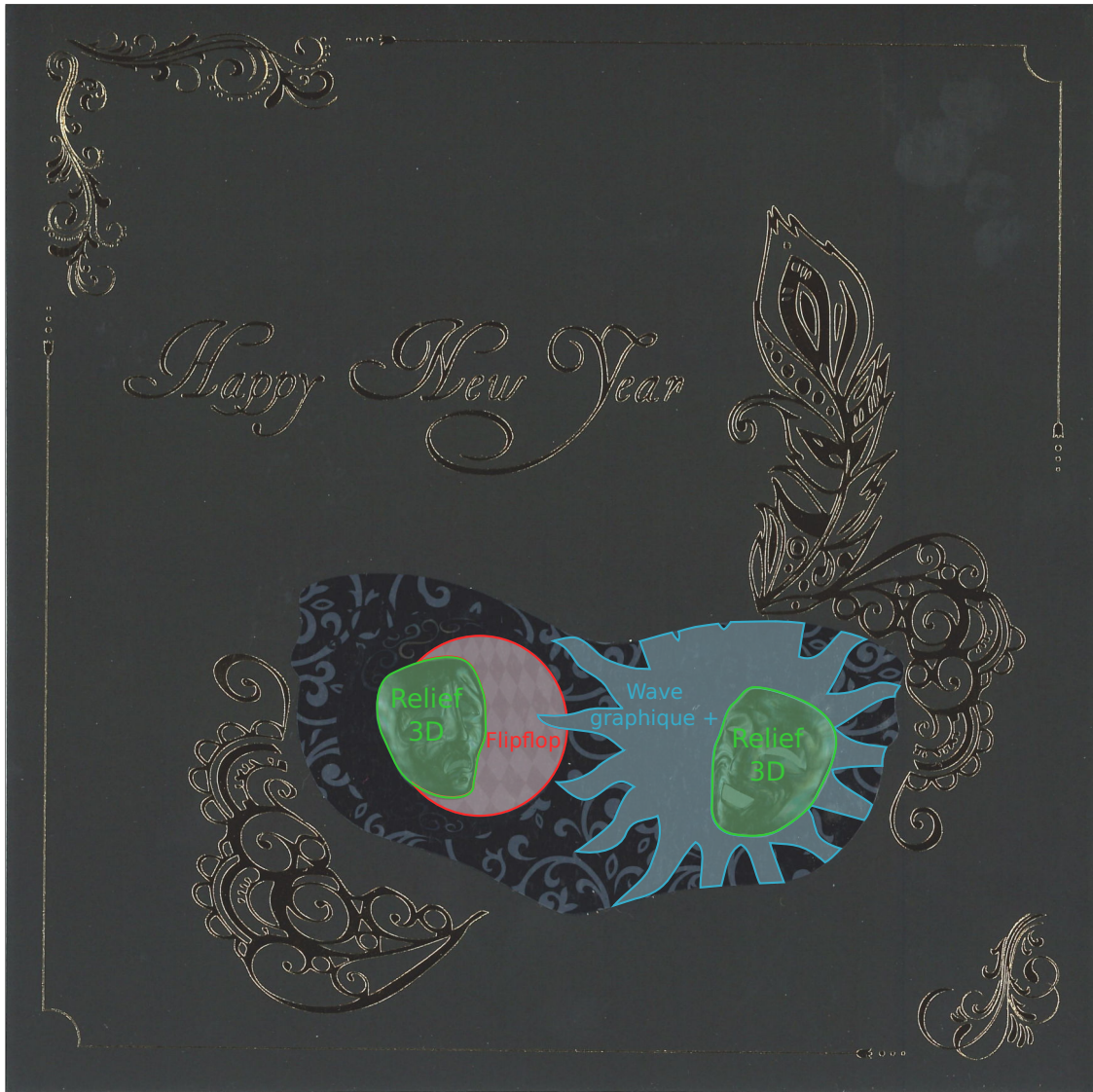
FIGURE E.3 – Carte de vœux 2019 de Surys. Cette carte contient les effets optiques «Reliefs 3D», «Wave graphique +» et «flip flop» (deux réseaux échelle de même période, mais d’orientation opposés).
