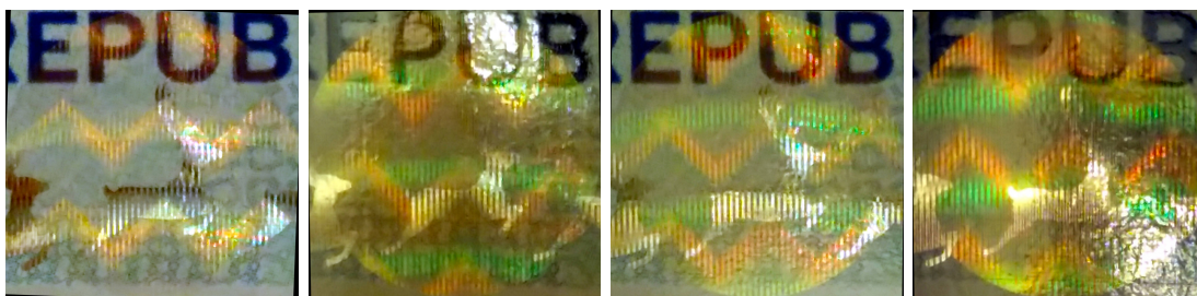
FIGURE 4.23 – Images d’un hologramme Surys prises à quatre angles consécutifs. Dans cet hologramme, nous observons un effet «DID™ Wave graphique entrelacée», d’un échantillon de démonstration de lamina de sécurité destiné aux passeports(voir échantillon E.2). Des chevrons rouges et des lignes courbes vertes montent et descendent en se croisant.
