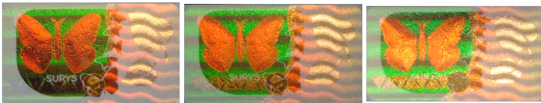
FIGURE 4.8 – Images d'un hologramme Surys prises à trois angles consécutifs. Nous pouvons observer un effet «DID™ Wave» (lignes horizontales en vert à gauche dans l'hologramme), «DID™ Wave graphique» (vagues en rouge à droite dans l'hologramme) et «DID™ Virtual» (papillon en rouge à gauche dans l'hologramme) (voir échantillons E.1a).
