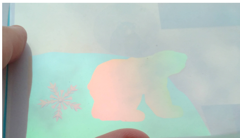
FIGURE 3.36 – Prototype précédant la création de l'échantillon de démonstration de lamina de sécurité E.2 destiné aux passeports.
