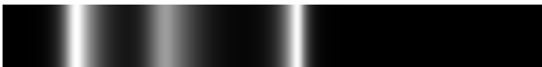
FIGURE 3.23 – Fichier image en niveaux de gris utilisé dans notre outil de simulation représentant le spectre normalisé d'une source LED blanche (figure 3.20) de 380 à 830 nm (de gauche à droite).
