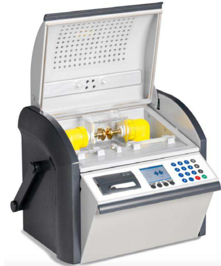
Figure 84 : Appareil « BAUR DPA 75 C » utilisé pour la rupture diélectrique des échantillons
