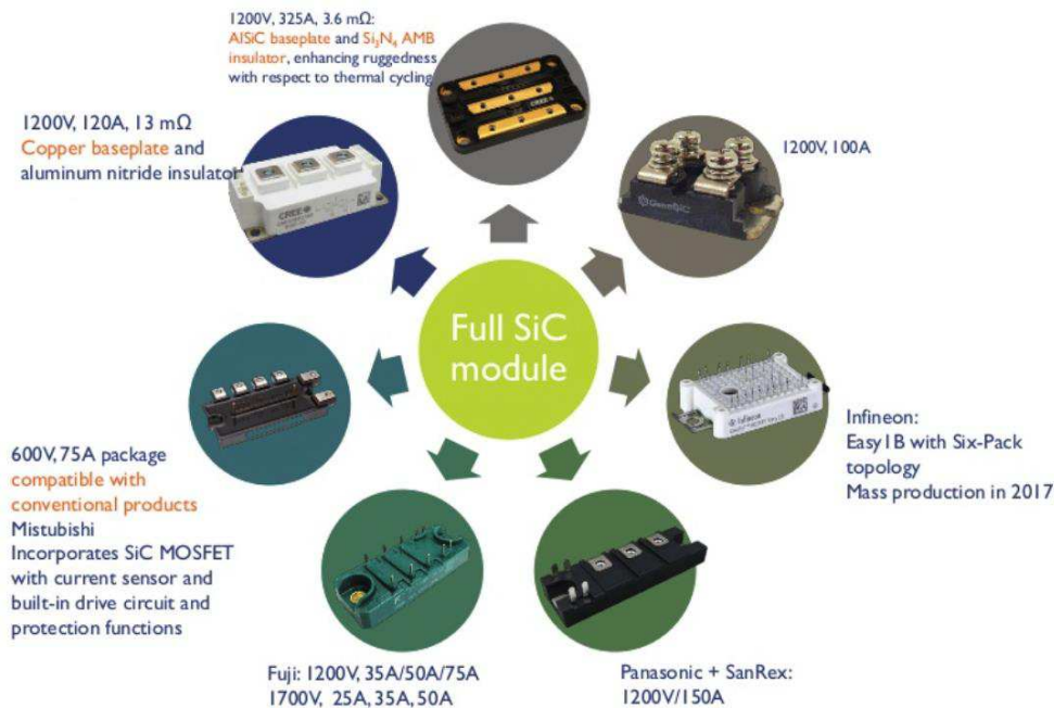
Figure 3 : Exemples de quelques modules de puissance hybrides ou tout SiC commerciaux [8]
