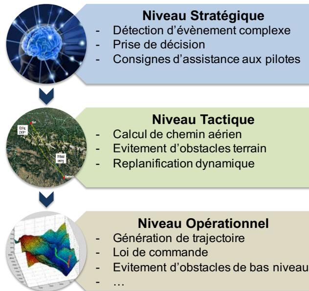
FIGURE 6.3 – Architecture décisionnelle du système d'assistance aux pilotes
