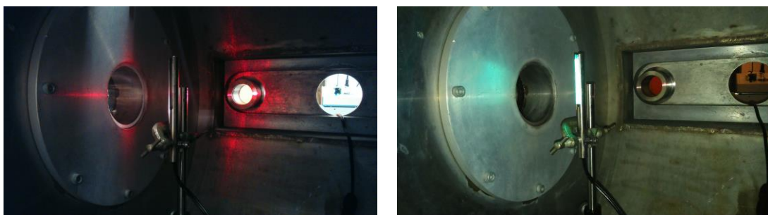
Figure B-29. Positionnement de la lampe crayon pour le réglage du montage spectroscopique.
