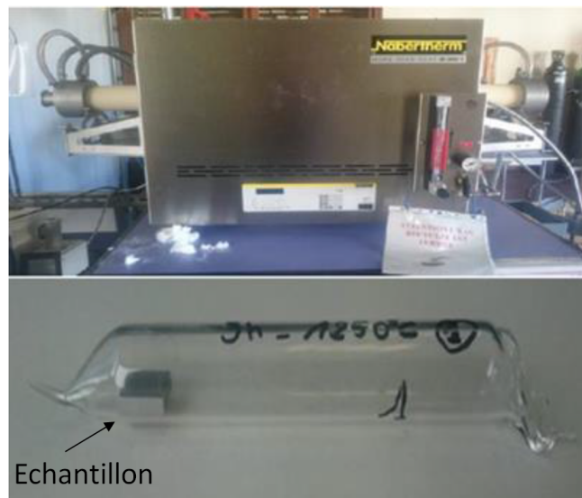
FIGURE II.3.3.1 – Four de traitement thermique
