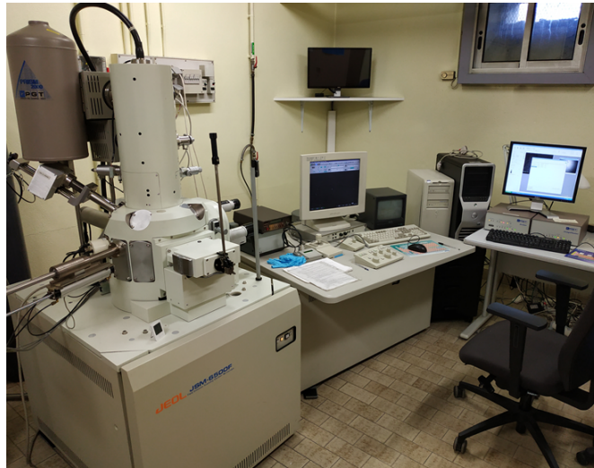
FIGURE II.3.4.3 – Microscope à balayage électronique JEOL JBM-6500F
