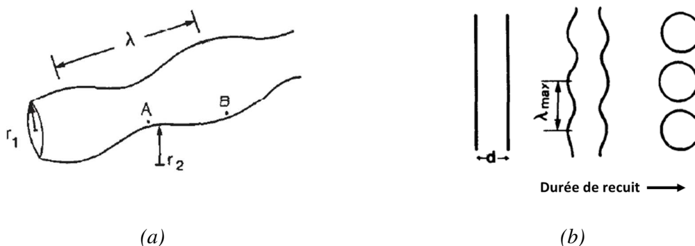
Figure I.11 - Représentation schématique d'une fibre infinie possédant une perturbation longitudinale de période \lambda . (a) représentation 3D, extraite de [42], et (b) évolution vue en coupe avec la durée de recuit dans le cas où \lambda = \lambda_{max} , d'après Tian et Kraft [38]. La valeur de \lambda définit si les instabilités se résorbent ou se développent et entraîne le fractionnement de la fibre.
