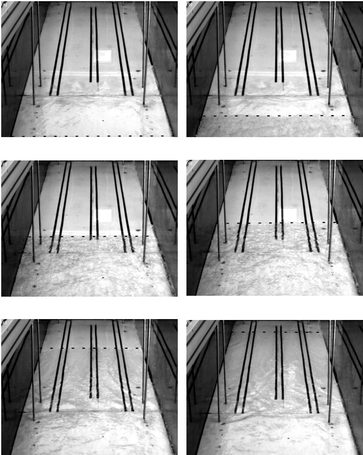
Figure 3.8. Variation temporelle du runup d'une vague solitaire (SW13). (a) : début du runup ( t=0 s) ; (b) : 0,06 s ; (c) : 0,21 s ; (d) : 0,26 s ; (e) : 0,49 s ; (f) : 0,78 s
