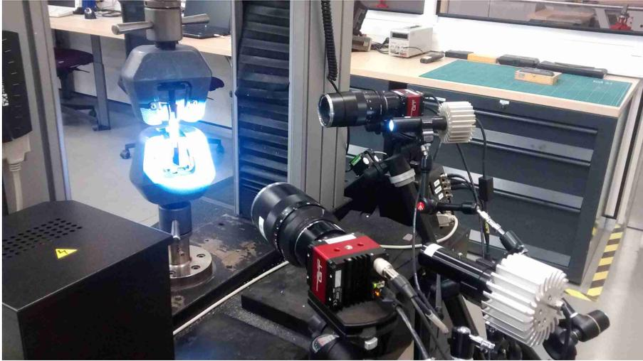
FIGURE 2.10 – Montage expérimental pour le suivi des dimensions de l'éprouvette
