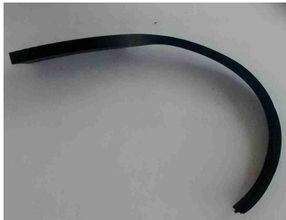
FIGURE 6.18 – Forme résiduelle des éprouvettes avec un vieillissement AIR+TP1 de 300h
