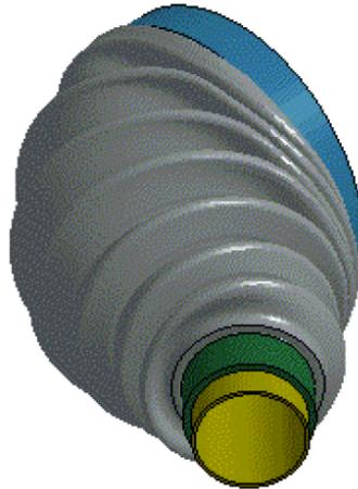
FIGURE 1.6 – Profil du soufflet mis en angle
