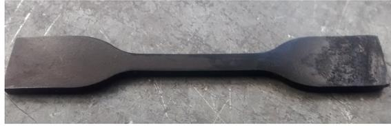
FIGURE 6.14 – Etat de surface des éprouvettes dans la graisse TP1 à 140 °C après 500h de vieillissement. La partie à droite de l'image se trouvait initialement dans la zone oxydée de la figure 6.12
