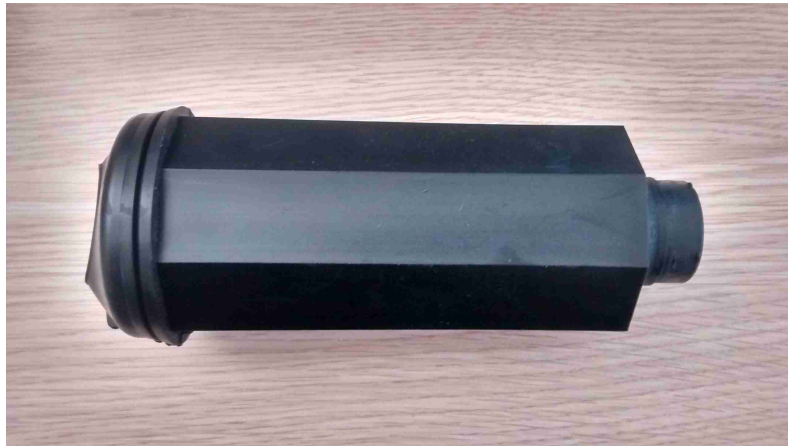
FIGURE 2.2 – Octogone obtenu par le procédé d’extrusion soufflage
