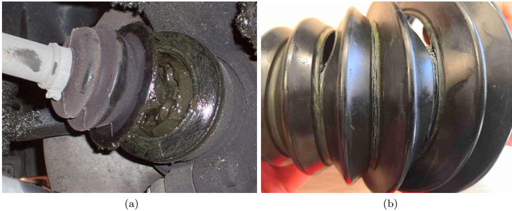
FIGURE 5.1 – Exemple de soufflet rompu en fatigue (a) sur véhicule, (b) sur banc.
