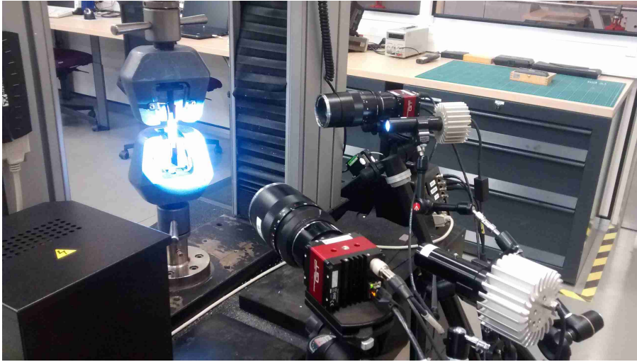
FIGURE 2.10 – Montage expérimental pour le suivi des dimensions de l'éprouvette
