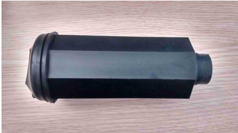
FIGURE 2.2 – Octogone obtenu par le procédé d’extrusion soufflage
