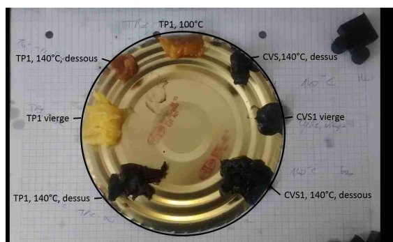
FIGURE 6.13 – Illustration des variations de couleurs des différentes graisses au cours des essais de vieillissement en fonction de la température et de la position dans le contenant
