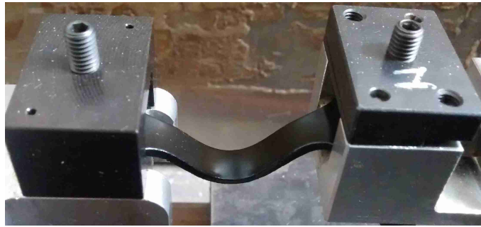
FIGURE 5.3 – Déformée de flexion l'éprouvette lors des phases en compression (déplacement négatif)
