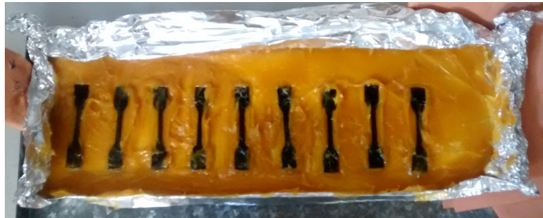
FIGURE 6.15 – Disposition des éprouvettes sur un lit de graisse pour un vieillissement air + graisse
