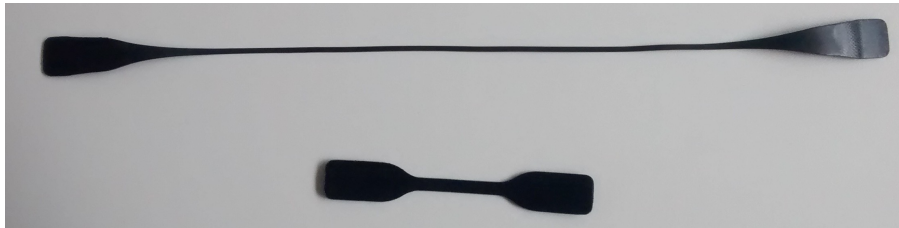
FIGURE 2.7 – Eprouvettes H4 avant et après essai de traction interrompu à XXX% de déformation
