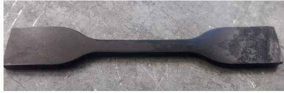
FIGURE 6.14 – Etat de surface des éprouvettes dans la graisse TP1 à 140 °C après 500h de vieillissement. La partie à droite de l'image se trouvait initialement dans la zone oxydée de la figure 6.12
