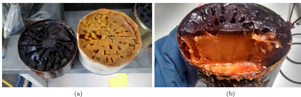
FIGURE 6.12 – (a) Graisse TP1 après 500h à 100 °C (droite) et 140 °C (gauche) (b) vue en tranche du contenant de TP1 après 500 h à 140 °C
