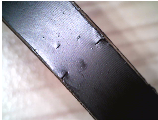
FIGURE 5.6 – Faciès d’une des éprouvettes non rompue (selon le critère défini dans la partie 5.3.2) au moment de l’arrêt de l’essai avec un excentrique de 12.5 mm et une température ambiante de 70 °C
