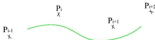
Figure annexe 4 : Tracé d'une spline de type B-spline.
