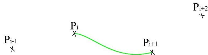
Figure annexe 5 : Tracé d'une spline de type Catmull-Rom.
