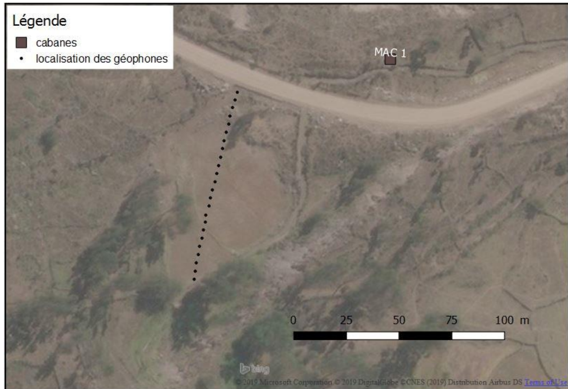
Figure 5-20 Localisations des 24 géophones pour le profil de sismiques actives (points noirs). Ce profil a été utilisé pour faire de la sismique de réfraction. La figure correspond à un agrandissement du carré noir visible dans la Figure 5-18.
