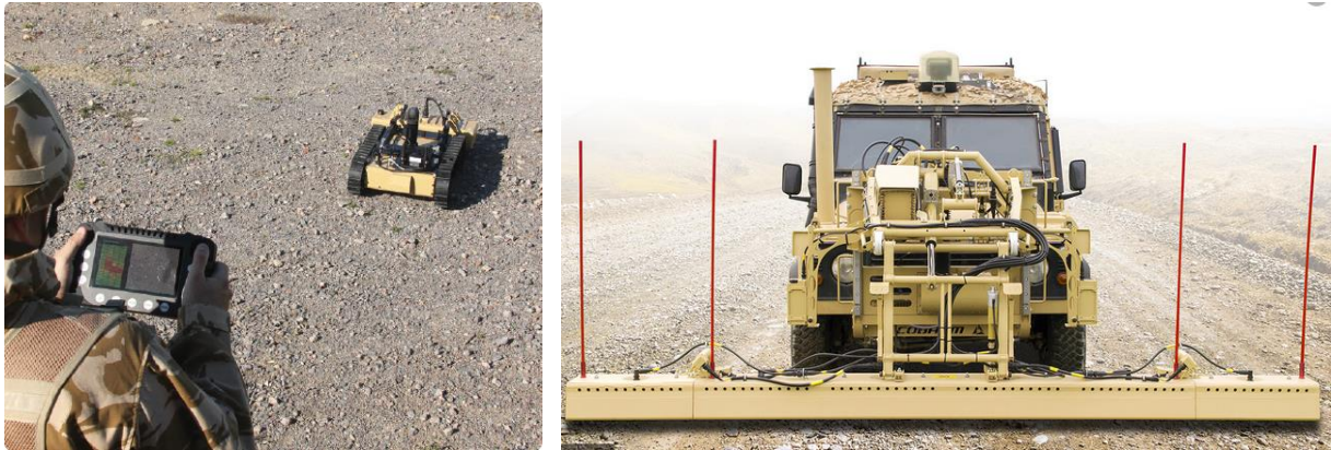
Figure I.18 : Cobham : systèmes SAR GPR [49].
