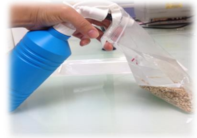
Figure 53 : Imprégnation du catalyseur chimique par aspersion
