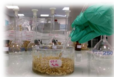
Figure 54 : Imprégnation du catalyseur par immersion
