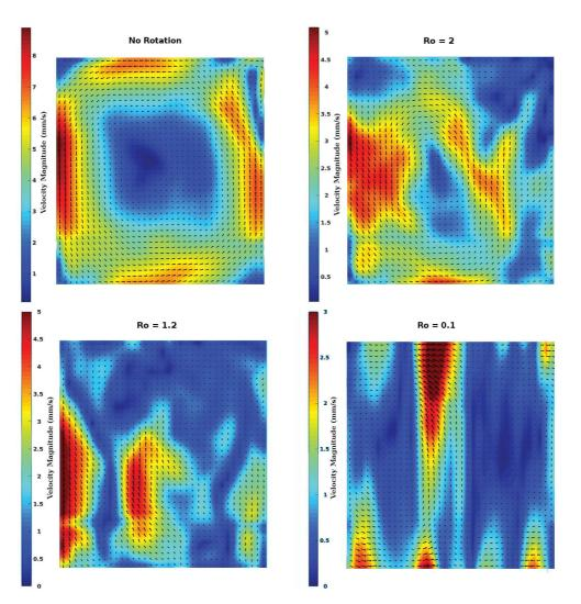
FIGURE 1: Champ de vitesse moyenne (sur 67secondes) et contour de la norme des vecteurs vitesses à Ro =  $\infty$  (haut à gauche, pas de rotation), Ro = 2 (haut à droite ), Ro = 1.2 (bas à gauche) et Ro = 0.1(bas à droite).
