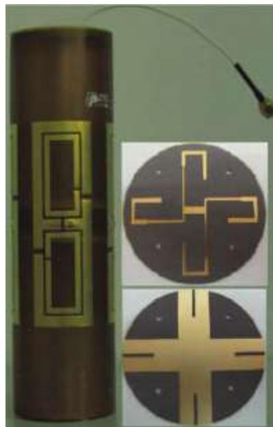
Figure 41 : antenne polarisée circulairement et à rayonnement omnidirectionnel
