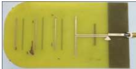
Figure 39: antenne yagi-uda sur ligne micro -ruban [50]
