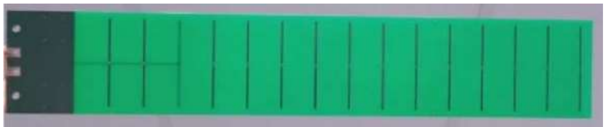
Figure 55 : antenne à éléments parasites à 4 éléments avec des composant CMS (à gauche), diagramme de rayonnement simulé et mesuré (à droite)
