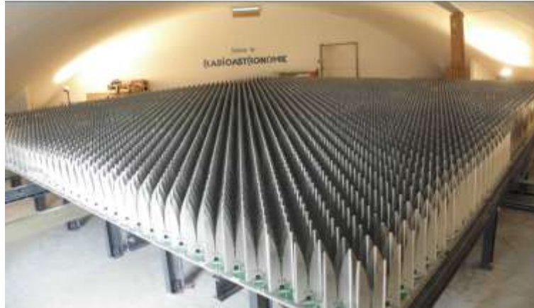
Figure 7 : prototype de réseau d'antennes pour le SKA, à Nançay [4]
