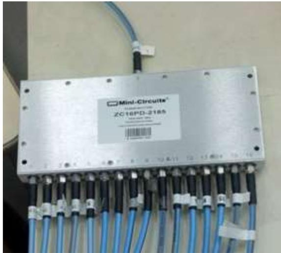
Figure 150 : diviseur de puissance 1 voie vers 16 (Mini-circuits - ZC16PD-2185 )
