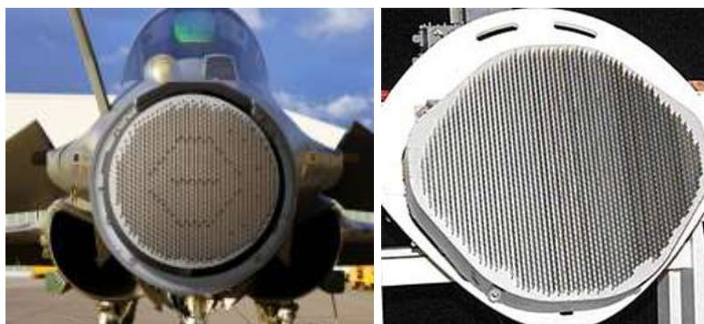
Figure 8: RBE2 équipant un rafale à gauche et An/APG-77 à droite
