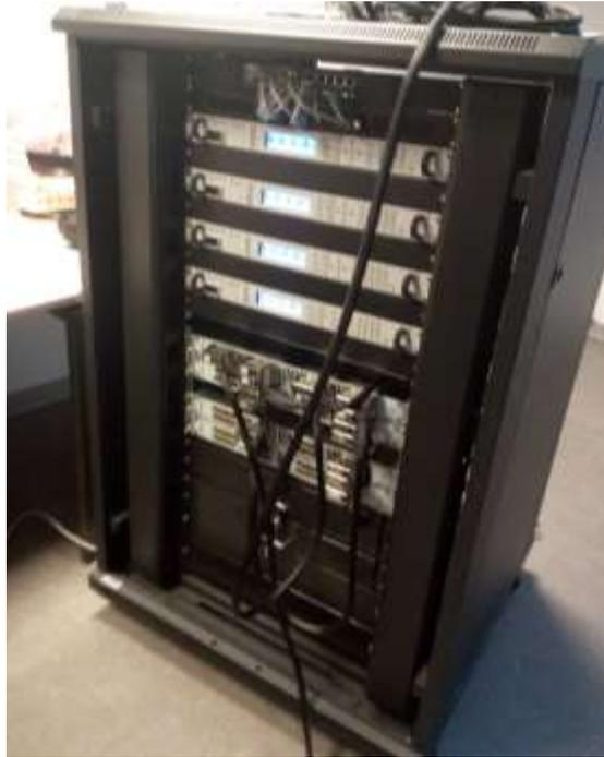
Figure 148 : banc de pilotages DC multivoies
