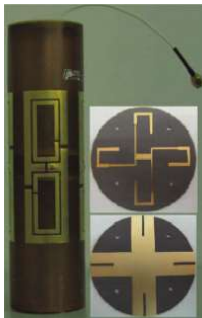
Figure 41 : antenne polarisée circulairement et à rayonnement omnidirectionnel
