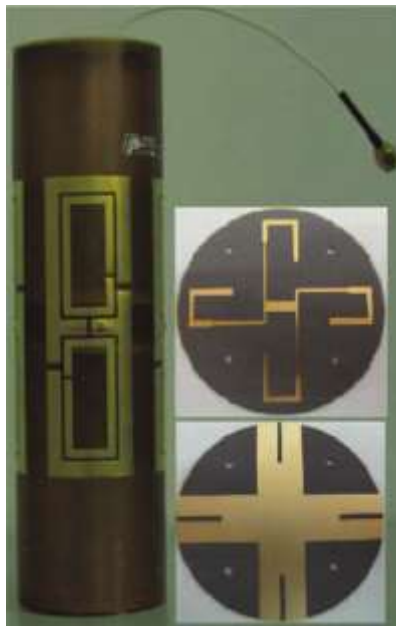
Figure 41 : antenne polarisée circulairement et à rayonnement omnidirectionnel
