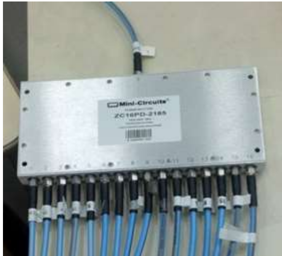
Figure 150 : diviseur de puissance 1 voie vers 16 (Mini-circuits - ZC16PD-2185 )
