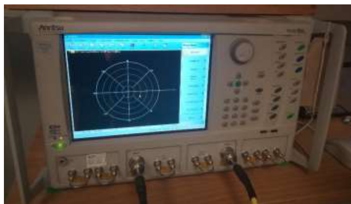
Figure 155 : l'ARV ANRITSU MS4644A utilisé pour les mesures
