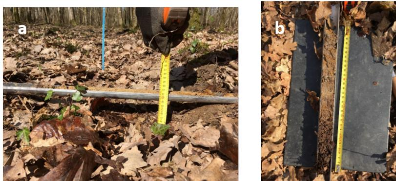
FIGURE 6.12 – Mesures expérimentales réalisées pour définir l'état de dégradation des cloisonnements. (a) Mesure de la profondeur d'ornièrre, (b) Mesure de la profondeur d'apparition des tâches d'hydromorphie.
