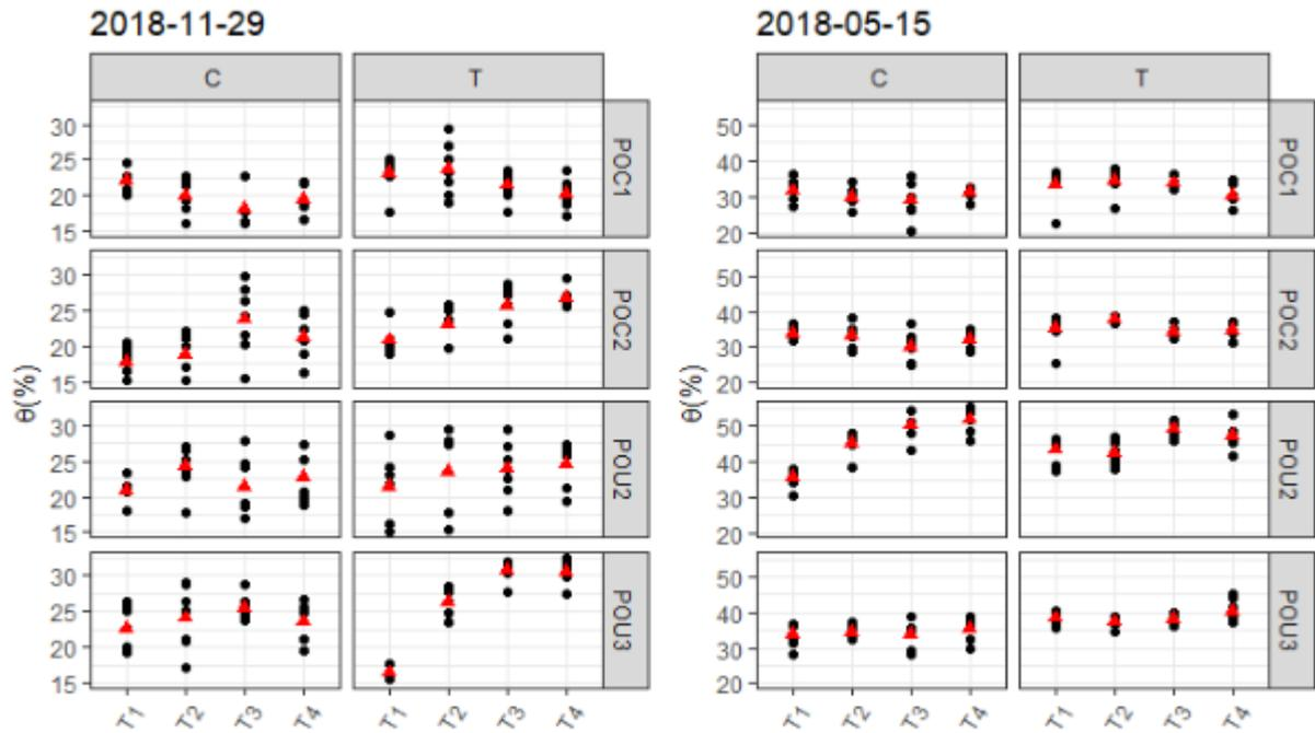
FIGURE 3.26 – Exemple de la variabilité des teneurs en eau mesurées par sondage TDR itinérant intra et inter transects à 2 dates. Les points noirs correspondent aux 7 mesures de  $\theta$  par transect et les triangles rouges à la moyenne du transect.
