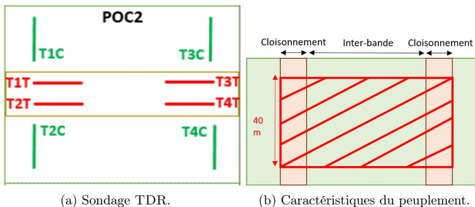
FIGURE 6.15 – Schémas des dispositifs expérimentaux : (a) Schéma du dispositif de mesure de la teneur en eau en surface sur les sites de Pochon et Purlans avec une sonde TDR, (b) Schéma du dispositif de mesure des caractéristiques du peuplement.
