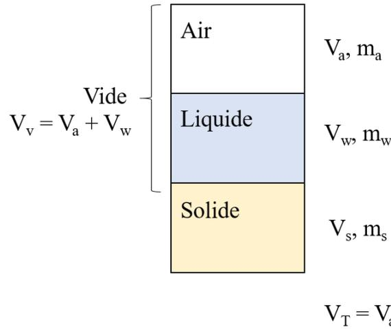
FIGURE 1.7 – Schéma simplifié des constituants d’un sol.  $V_a$ ,  $V_w$ ,  $V_s$ ,  $V_v$  et  $V_T$  sont respectivement le volume de la phase gazeuse, de la phase liquide, de la phase solide, des vides et total.  $m$  est la masse.
