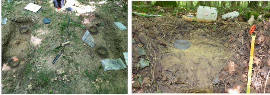
FIGURE 6.13 – Tests d’infiltration réalisés à 0-10 et 15-25 cm de profondeur sur l’ensemble des sites de l’observatoire des cloisonnements afin d’estimer les paramètres hydrodynamiques selon la méthode BEST.
