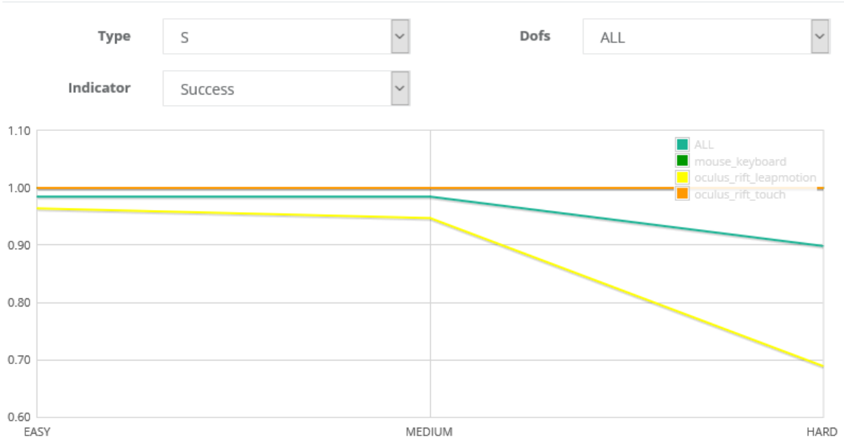
FIGURE 5.7 – Évolution du taux de succès en fonction de la difficulté pour les tâches de sélection
