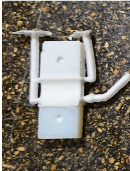
FIGURE 4.20 – Charnière obtenue en sortie de moule, avant retrait des canaux de moulage et de dégazage.
