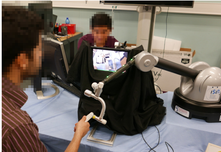
FIGURE 2.11 – Vue du dispositif tel qu'utilisé pendant les expériences. L'utilisateur manipule l'outil en collaboration avec un robot et en s'aidant du retour visuel affiché sur le moniteur. Il donne ensuite sa réponse en appuyant sur l'échantillon choisi en appuyant sur la zone dédiée.
