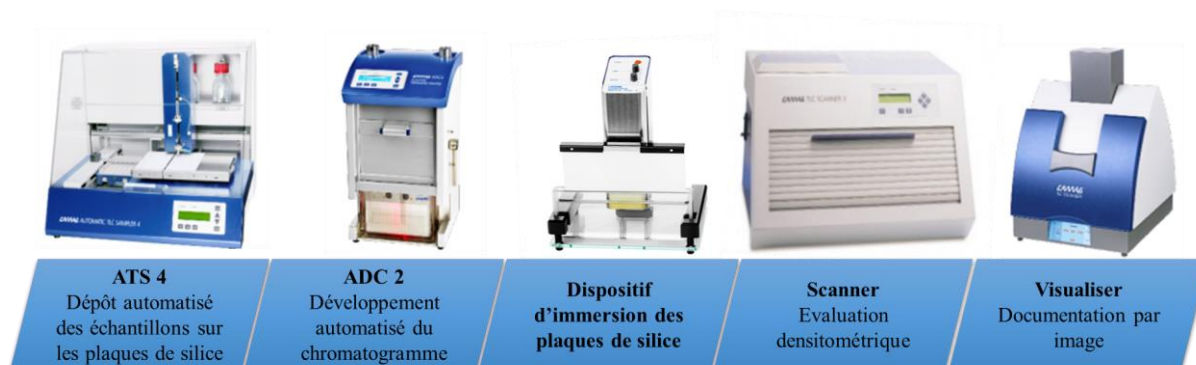
Figure II.2. Les différentes composantes de l'HPTLC
