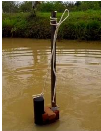
Figure 38 : A. gigas équipé d'un émetteur ultrasonique (16 x 80 mm, 76 KHz) de 35 g (MM-M-16-50 PM, LOTEK Inc.) (a) et hydrophone (WHS 3250D, LOTEK Inc.) fixé sur un poteau métallique et immergé à la périphérie de l'étang expérimental (b).
