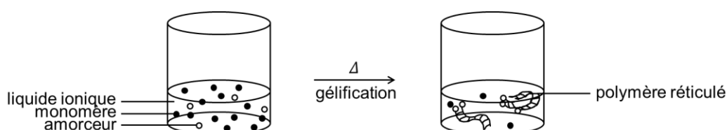
Figure 49. Gélification chimique du liquide ionique par formation d'un polymère réticulé.
