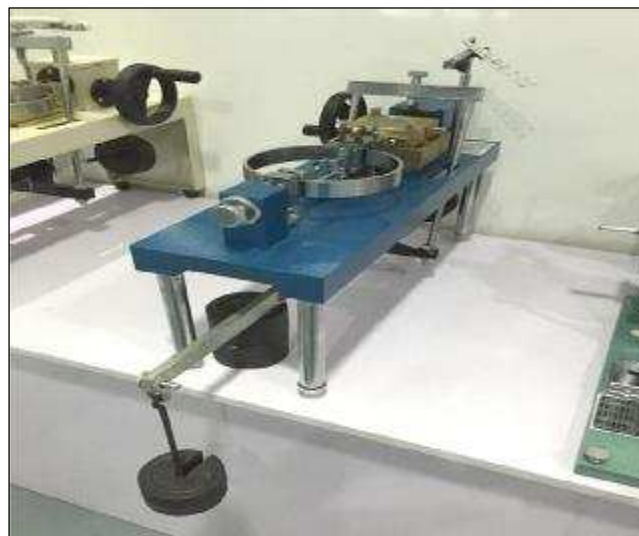
Figure 2.5-5. Bâti de cisaillement direct et contrôles des déformations
