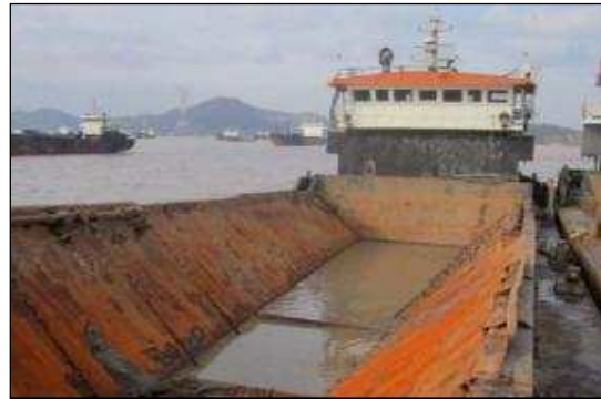
Figure 3.4-9. Chaland pour le transport, stockage et mélange des sédiments de dragage
