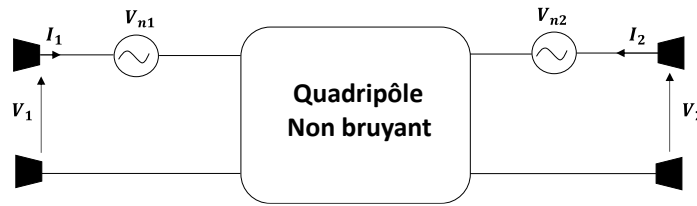
Figure 1.3 : Représentation des sources de bruit de type série d'un quadripôle bruyant.
