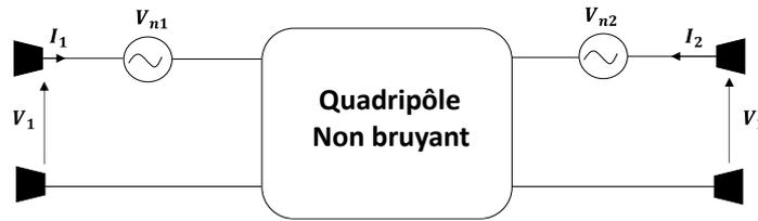
Figure 1.3 : Représentation des sources de bruit de type série d'un quadripôle bruyant.
