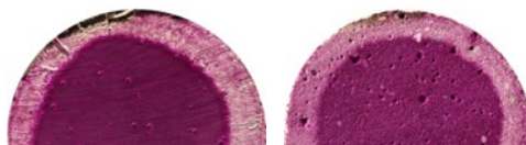
Figure 7 - 7 : Comparaison de la profondeur de carbonatation naturelle d'une pâte OPC6 (à gauche) et d'un mortier OPC6 (à droite) après 21 mois
