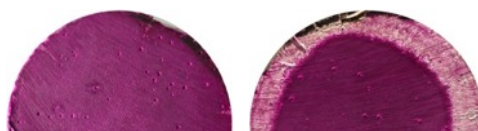
Figure 7 - 6 : Exemple de visualisation des profondeurs de carbonatation pour les pâtes OPC4 (à gauche) et OPC6 (à droite) après 21 mois de carbonatation naturelle
