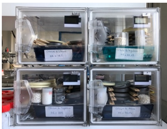
Figure 2 - 4 : Stockage dans les dessiccateurs des échantillons à humidité relative contrôlée
