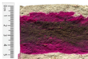
Figure 7 - 8 : Pulvérisation de phénolphtaléine sur un échantillon de mortier BFS6 en carbonatation naturelle axiale pendant 21 mois
