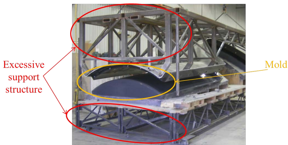
Figure 11 Photographie d'un moule industriel avec des supports [30]
