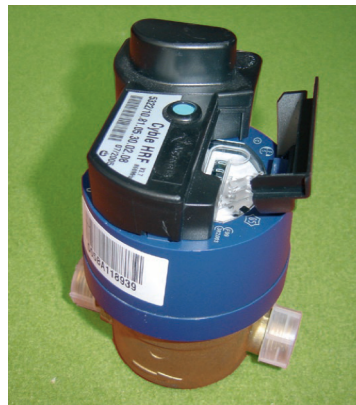
FIGURE 1.2 – Compteur communicant installé au niveau de chaque bâtiment permettant de transférer les données de consommation
