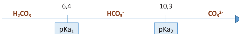
FIGURE B.1 – Diagramme de prédominance des espèces lors de la dissolution du \text{CO}_2 en fonction du pH
