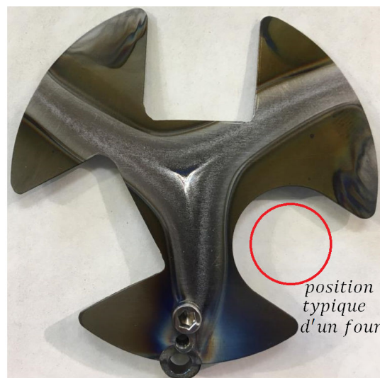
FIGURE 1.22 – Photo d'une électrode après qu'elle est été au niveau de l'injection d'une source d'ions. Le flux de particules atteignant l'injection de la source d'ions est responsable de l'érosion de cette dernière, par pulvérisation. Toutes les sources d'ions RCE présentent le même phénomène [66,67].
