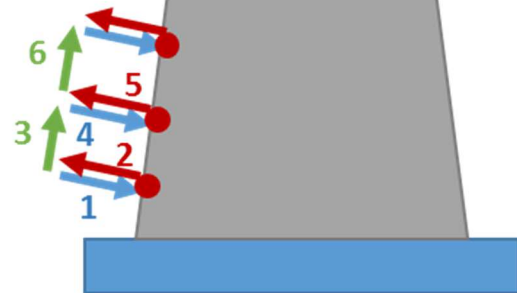
Figure III.12 : Principe de déplacement de la pointe pour le mode "CD".
