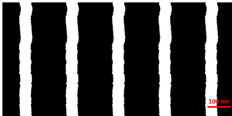
Figure IV.8 : Réseau de lignes identiques générées sur le type corrélé pour un paramétrage \sigma = 2.0 \text{ nm} \alpha = 0.5 et \xi = 20 \text{ nm} , Dy = 1 \text{ nm} , CD = 50 \text{ nm} et \text{pitch} = 200 \text{ nm} . Seule une infime partie de la longueur de la ligne est visible ici.
