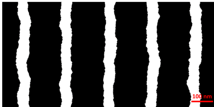
Figure IV.9 : Réseau de lignes différentes, générées grâce à la somme des contributions de signaux de type anti-corrélé : \sigma = 2.0 \text{ nm} \alpha = 0.5 et \xi = 20 \text{ nm} et corrélé : \sigma = 5.0 \text{ nm} \alpha = 0.8 et \xi = 50 \text{ nm} avec D_y = 1 \text{ nm} , CD = 50 \text{ nm} et \text{pitch} = 200 \text{ nm} . Seule une infime partie de la longueur de la ligne est visible ici.
